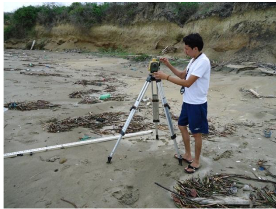
Fotografía N° 53 y 54: Medición del perfil de la playa con el nivel electrónico top com y la mira
