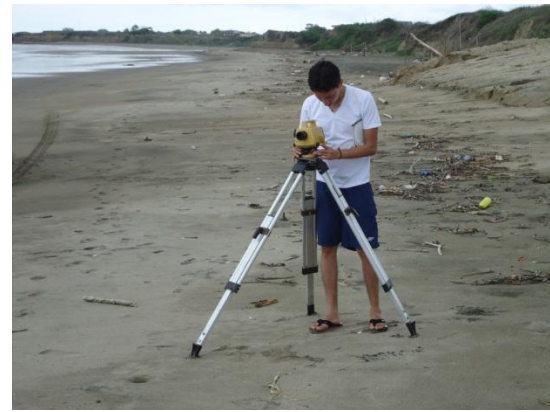
Fotografía N° 53 y 54: Medición del perfil de la playa con el nivel electrónico top com y la mira
