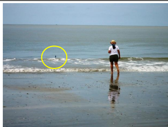
Fotografía N° 43 44: Lanzamiento de la botella o flotador para medición de corriente litoral en la estación 2
