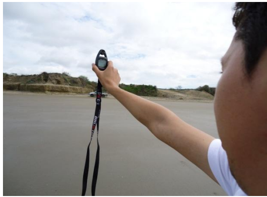
Fotografía N° 47: Medición de vientos con el anemómetro
