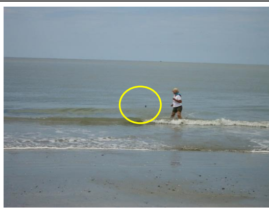
Fotografía N° 43 44: Lanzamiento de la botella o flotador para medición de corriente litoral en la estación 2
