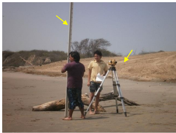
Fotografía N° 7: Mira y nivel electrónico top com
