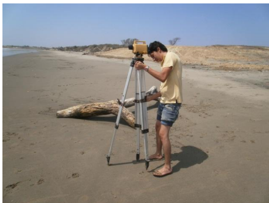
Fotografía N° 5: Nivel electrónico top com para medición de perfiles de playa
