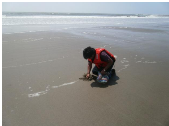
Fotografía N° 33: Toma de muestras de arena en la estación 2 en la parte alta de la playa para el análisis de granulometría
