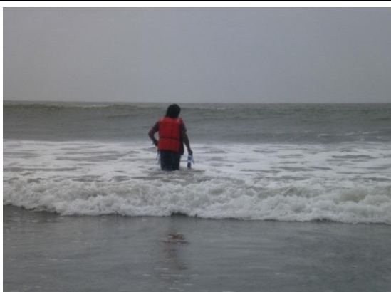
Fotografía N° 27: Lanzamiento de la botella o derivador para medición de la corriente litoral de la estación 2
